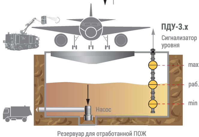
Функциональная схема системы контроля уровня ПОЖ
