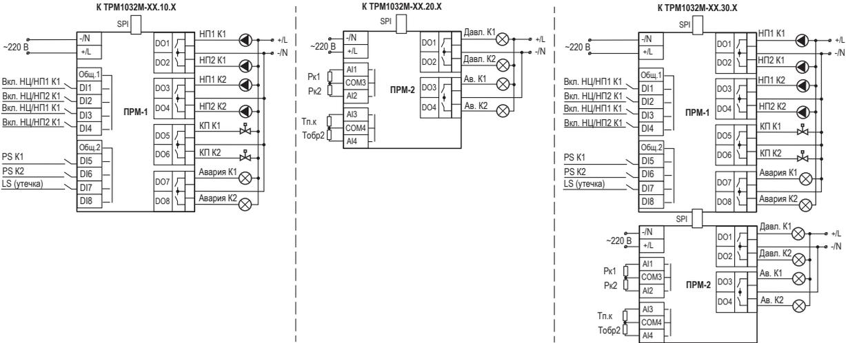
Схемы подключения модулей расширения
