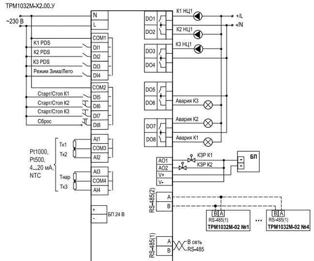
Схема подключения TRM1032M-X2.00.Y
