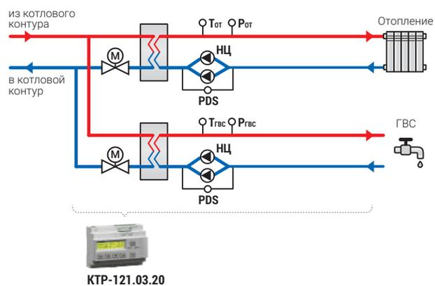
**Два контура отопления без подпитки**
