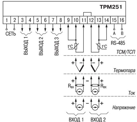
**СХЕМЫ ПОДКЛЮЧЕНИЯ ВЫХОДОВ**
