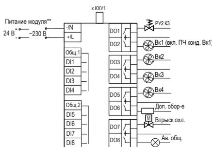
Пример схемы подключения трёх компрессоров с разгрузкой (по два разгрузчика на каждом компрессоре), четырёх вентиляторов с индивидуальными сигналами защиты, функция «Термостат», функция «Антизалив», реле аварии.
