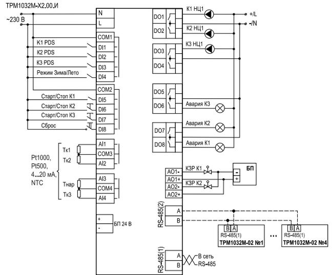
Схема подключения TPM1032M-X2.00.И
