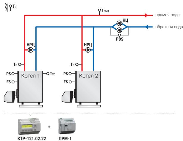
**Для каскада 2-х котлов с контурами отопления и ГВС через гидрострелку**
