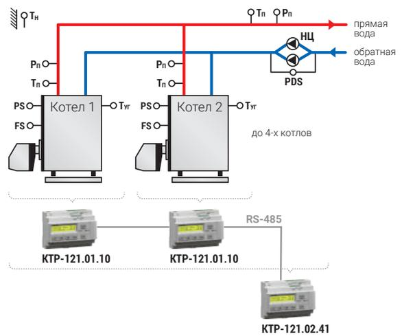
**Для каскада до 4-х котлов с регулированием общей температуры обратной воды насосом байпаса**
