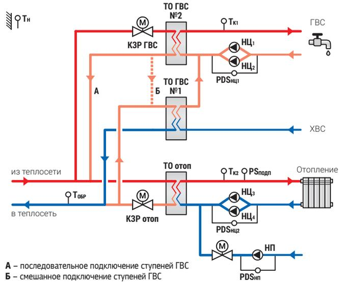
A – последовательное подключение ступеней ГВС
