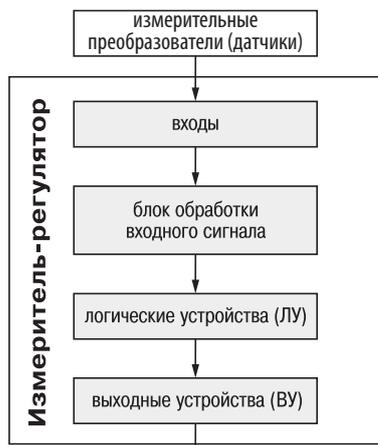
**Измерители-регуляторы температуры состоят из следующих функциональных блоков (см. рисунок):**
