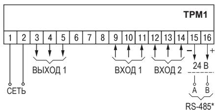
Схема расположения и назначение клемм ТРМ1
