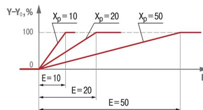
Зависимость выходного сигнала П-регулятора от рассогласования при различных значениях  $Xp$
