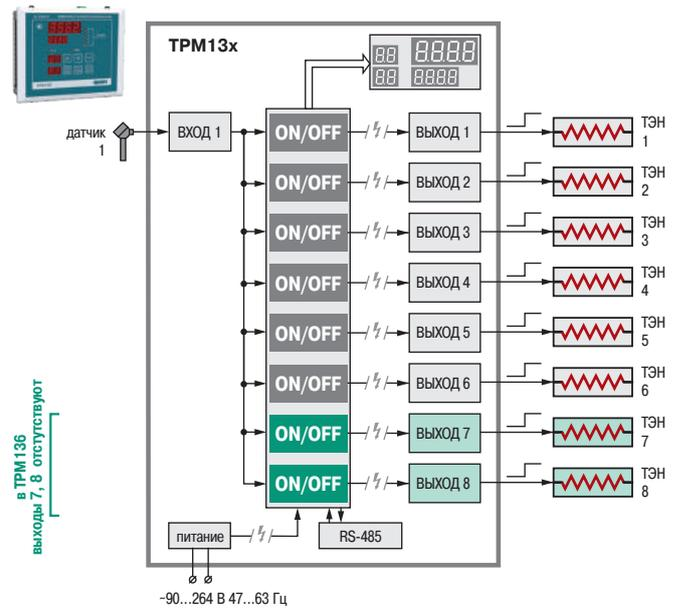
Одноканальный двухпозиционный регулятор с 6-ю или 8-ю уставками, может использоваться для контроля температуры одним датчиком и поддержания по двухпозиционному (ON/OFF) закону шести (восьми) независимых уставок.
