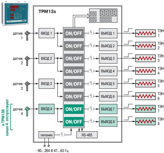
3- или 4-канальный трехпозиционный регулятор, может использоваться для контроля температуры и двухступенчатого управления процессом нагрева в технологическом оборудовании, содержащем до четырех зон нагрева и требующем быстрого разогрева при начале работы (в хлебопекарных печах, термопластавтоматах, экструдерах и др.).
