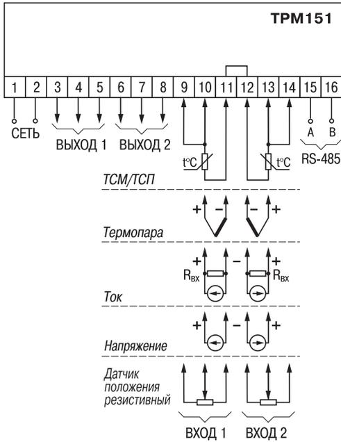
**СХЕМЫ ПОДКЛЮЧЕНИЯ ВЫХОДНЫХ ЭЛЕМЕНТОВ**
