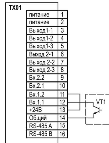
Подключение пассивных датчиков п-р-п-типа с открытым коллекторным входом при работе датчика от внутреннего источника питания
