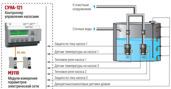
\* Логика управления на «откачку» или «наполнение» устанавливается пользователем в настройках контроллера.
