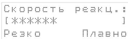
Крайнее левое положение индикатора на шкале соответствует наиболее быстрой реакции, но менее точному регулированию. С каждым последующим смещением шкалы вправо скорость реакции уменьшается, но увеличивается точность. Значения, близкие к крайнему левому положению, рекомендуется выбирать для небольших малоинерционных систем. Значения, близкие к крайнему правому положению, рекомендуется выбирать для высокоинерционных систем.
