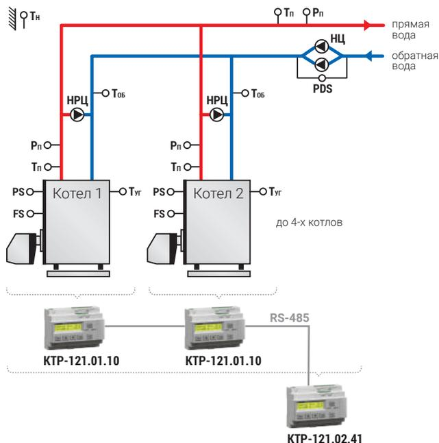
**Для каскада до 4-х котлов с контролем их параметров и индивидуальным управлением контурами отопления с подпиткой и ГВС через теплообменник**
