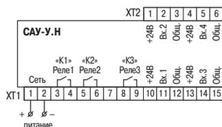
Схема подключения прибора в настенном корпусе Н
