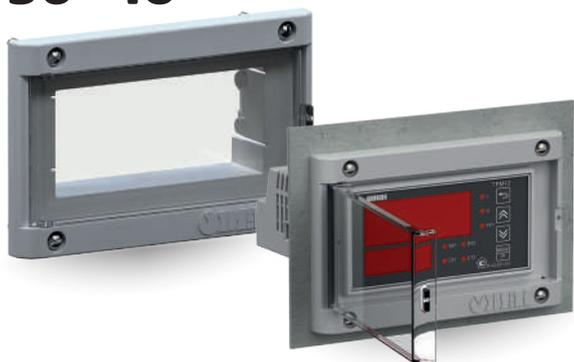
Предназначена для монтажа приборов в корпусах Щ2 (для приборов с лицевой панелью 96×48 мм). Рамка скрывает неровности монтажного отверстия, размер которого с учетом неровностей не превышает 112×56 мм.
