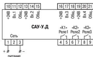
Схема подключения прибора в DIN-реечном корпусе Д
