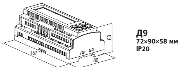
Приборы OWEN выпускаются в корпусах щитового, настенного или DIN-реечного крепления.
