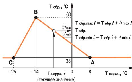
Пример графика температуры обратной воды —  $T_{обр.} = f(T_{наруж.})$
