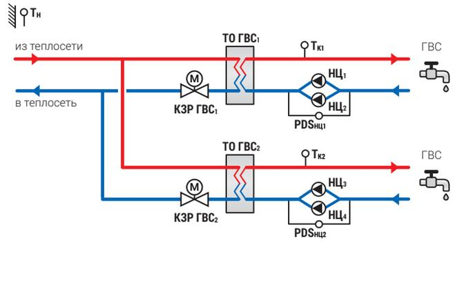
**Одноступенчатая ГВС + Отопление**
