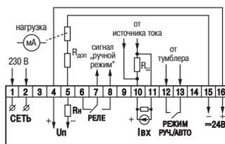
Предназначен для ручного или автоматического управления аналоговыми исполнительными механизмами. В автоматическом режиме УЗС1 транслирует сигнал от управляющего прибора или контроллера на исполнительный механизм, а в ручном – формирует сигнал 4...20 мА или 0...10 В, значение которого задается пользователем с лицевой панели.
