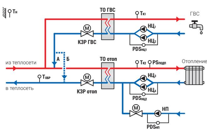
**Двухступенчатая ГВС + Отопление**
