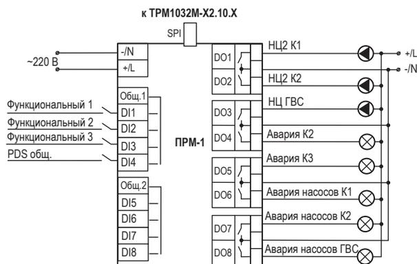
Схема подключения модуля расширения к TPM1032M-X2
