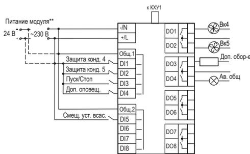
Пример схемы подключения пяти компрессоров, пяти вентиляторов с индивидуальными сигналами защиты, дистанционный пуск по кнопке, сигнал дополнительного аварийного оповещения, сигнал для смещения установки всасывания, функция Термостат, реле аварии
