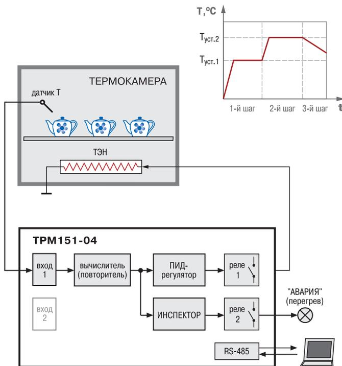
Использование ТРМ151-04 при термообработке керамики для регулирования температуры в камере, с возможностью аварийной сигнализации ПИД-регулирование температуры осуществляется с помощью ТЭНа. Программа регулирования состоит из 3-х шагов, каждый с заданной длительностью: 1-й шаг – нагрев и выдержка при температуре  $T_{уст.1}$ , 2-й шаг – то же при  $T_{уст.2}$ , 3-й шаг – охлаждение. Второе реле прибора используется для аварийной сигнализации, например, при перегреве.
