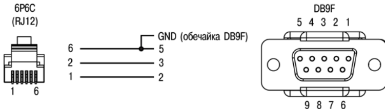
Рисунок Г.2 – Схема кабеля КС2
