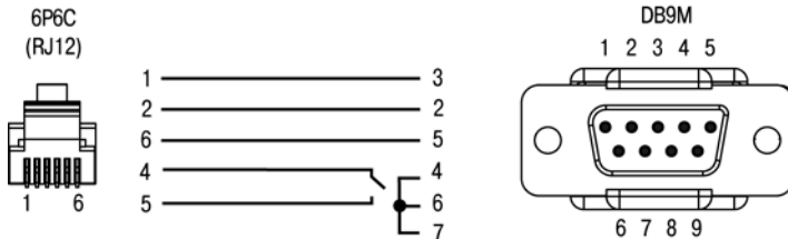
Рисунок Г.3 – Схема кабеля КС3 «ПЛК–Модем»
