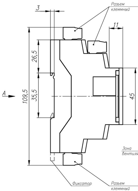
Расположение зон вентиляции и подключения проводов
