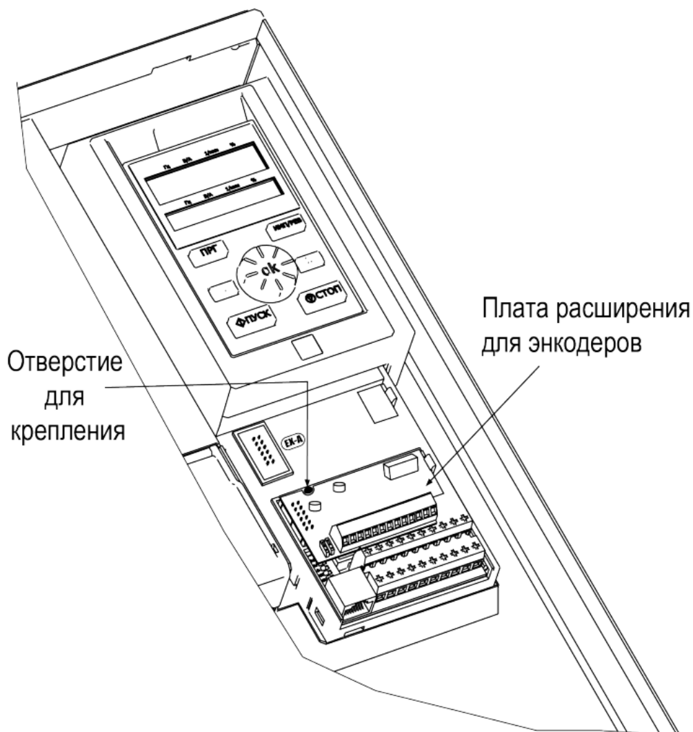
Рисунок 1. Монтаж платы расширения для энкодеров
